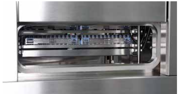
Im Gefriertrockner durch CIP/SIP automatisch reinig- und sterilisierbare Rahmen
