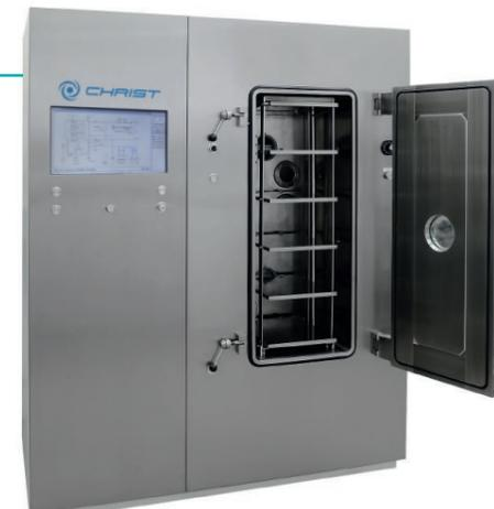
Die Epsilon 2-16D LSCplus bietet bis zu 1,44 m<sup>2</sup> Stellfläche. Sie wurde speziell konzipiert zur 24/7-Produktion von Schalenware (bulk) wie z.B. Pharma-Rohmaterial, Bakteriensuspensionen, aber auch von speziellen Formaten wie MTPs oder hohen Behältern, die keinen Verschluss benötigen.
