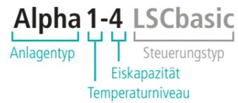
Abhängig von den eingesetzten Lösemitteln werden je nach Grundtyp unterschiedliche Eiskondensator-Temperaturen angeboten:
