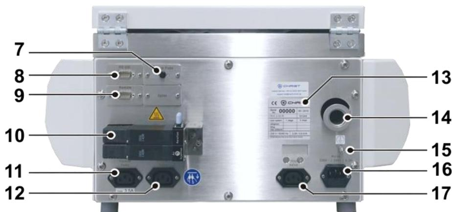
Fig. 73: Vue arrière du concentrateur sous vide
