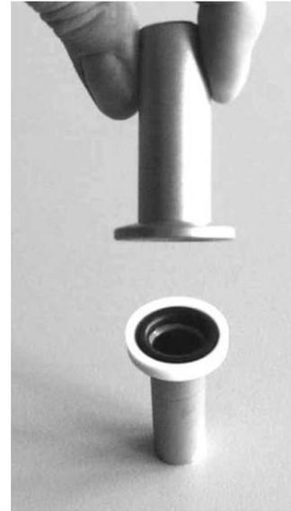
Fig. 60: Petite bride avec bague de centrage placée et petite bride
