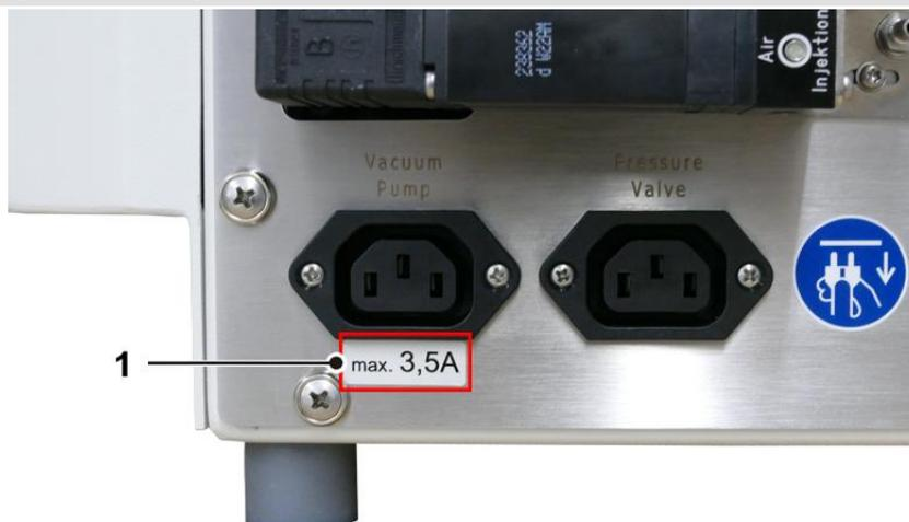
Fig. 10 : Indication de la puissance électrique maximale délivrée à la pompe à vide (exemple)
