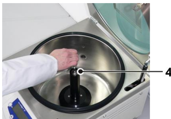
Fig. 56: Démontage de la vis à hexagone intérieur
