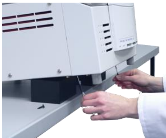
Fig. 50: Déverrouillage des verrous du couvercle
