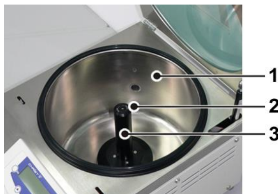
Fig. 55: Chambre du rotor et support du rotor
