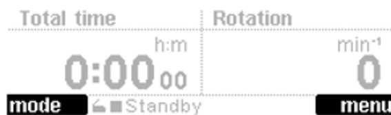
Fig. 21: Indication de l'action des touches de fonction, ici la touche gauche appelle la fonction « mode » et la touche de droite appelle la fonction « menu »
