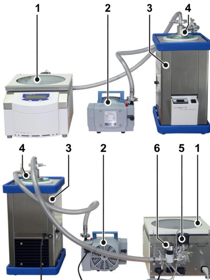
Fig. 13: Combinaison du concentrateur sous vide avec une pompe à vide et un piège cryogénique
