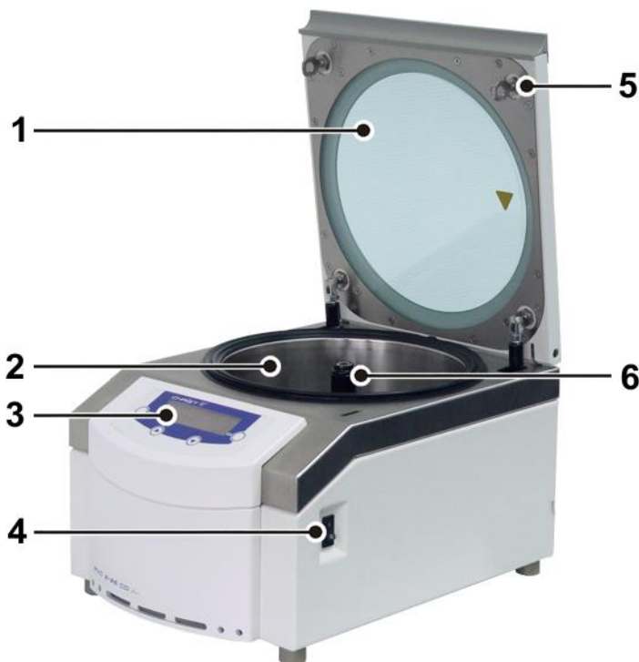
Fig. 1: Vue d'ensemble du concentrateur sous vide
