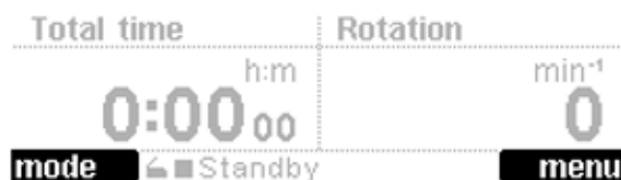
Fig. 21: Indication de l'action des touches de fonction, ici la touche gauche appelle la fonction « mode » et la touche de droite appelle la fonction « menu »
