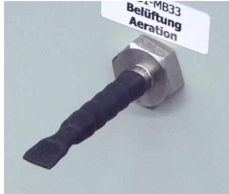
Abb. 6: Schlauchtülle des Belüftungsventils mit Schrumpfschlauch (Beispielabbildung)
