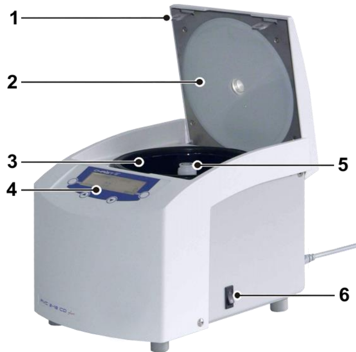
Abb. 1: Übersicht über den Rotations-Vakuum-Konzentrator
