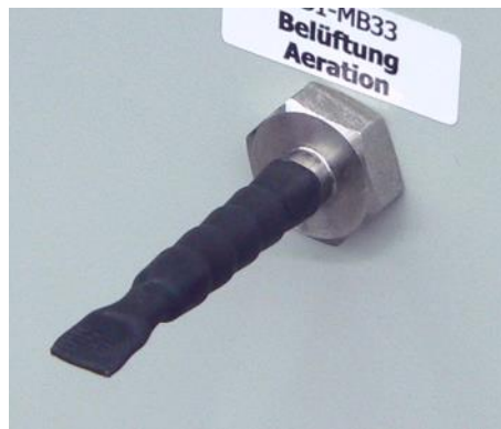
Abb. 5: Schlauchtülle des Belüftungsventils mit Schrumpfschlauch (Beispielabbildung)
