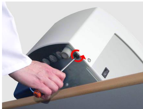
Abb. 35: Lösen der Kreuzschlitzschraube
