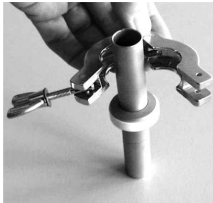
Abb. 40: Ansetzen des Spannrings
