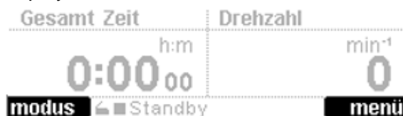
Abb. 17: Anzeige der Belegung der Funktionstasten; hier links die Funktion „modus“, rechts die Funktion „menu“
