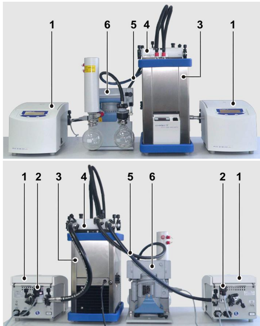
Abb. 12: Kombination von zwei RVC mit Vakuumpumpe und Kühlfalle mit Verteilerblock, Front- und rückseitige Ansicht
