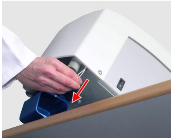
Abb. 37: Manuelle Entriegelung des Deckelschlosses
