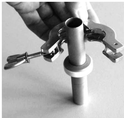
Abb. 71: Ansetzen des Spannrings
