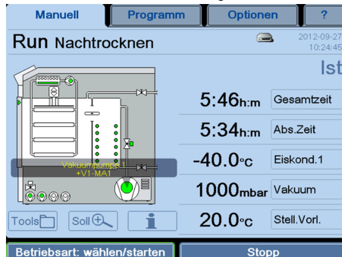
Abb. 22: Darstellung eines Anlagenschemas mit Bezeichnung und Betriebsmittelkennzeichen
