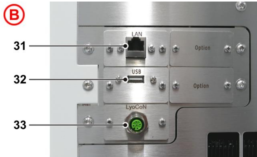
Abb. 6: Detailansicht B – Anschlüsse an der Rückseite der Gefriertrocknungsanlage
