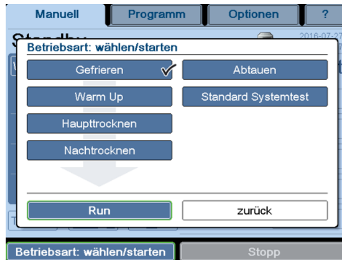
Abb. 26: Dialogfenster "Betriebsart wählen / starten" (Anzeige variiert je nach Ausstattung der Gefriertrocknungsanlage)
