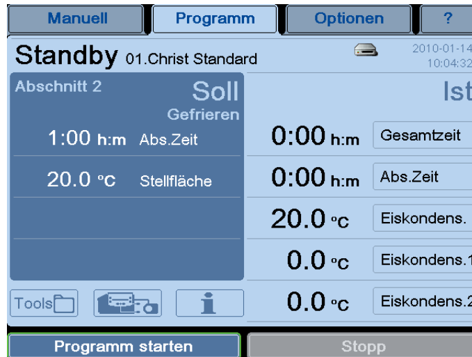
Abb. 68: Mit "Programm starten" wird der Gefriertrocknungsprozess in Gang gesetzt.
