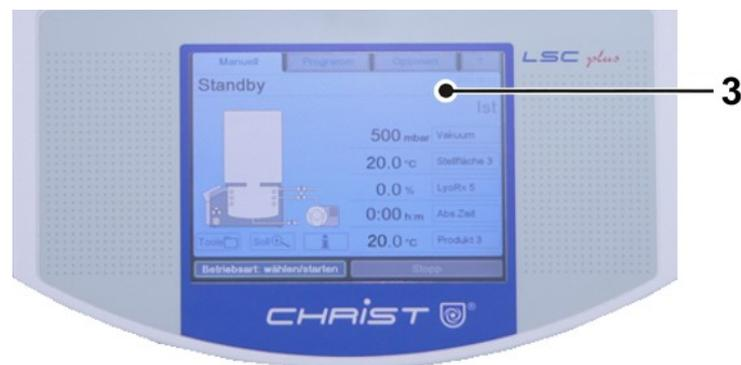
Fig. 2 : Panneau de commande avec écran tactile
