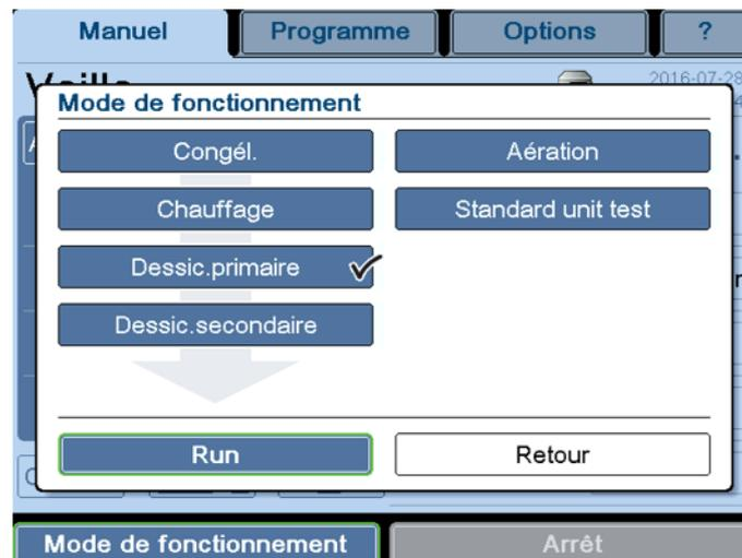
Fig. 32 : Fenêtre de dialogue « Mode de fonctionnement » Cette fenêtre varie en fonction de l'équipement du lyophilisateur)
