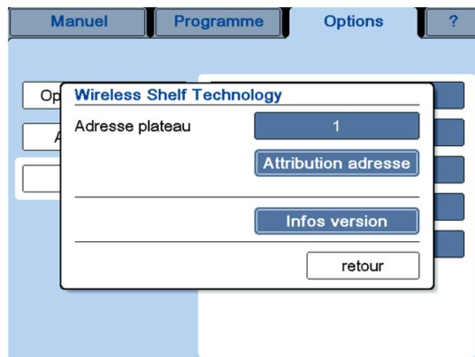
Fig. 52 : Technologie de plateau sans fil (Wireless Shelf Technology) – Adressage des plateaux
