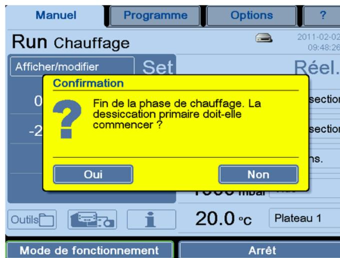
Fig. 56: Fenêtre de dialogue s'ouvrant à la fin de la phase de chauffage
