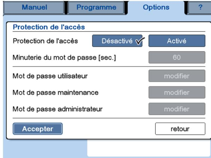
Fig. 44 : Fenêtre de dialogue « Protection de l'accès »
