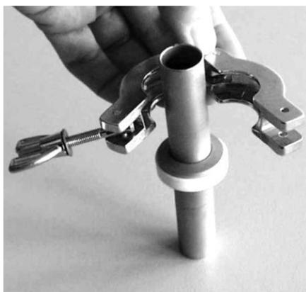
Fig. 72 : Montage du collier de serrage
