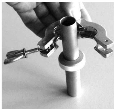
Fig. 43 : Montage du collier de serrage
