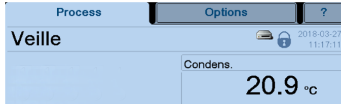
Fig. 29 : Accès verrouillé, aucune modification possible
