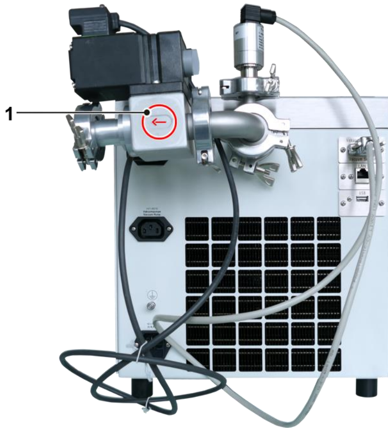
Fig. 18 Installation de la vanne régulatrice de pression
