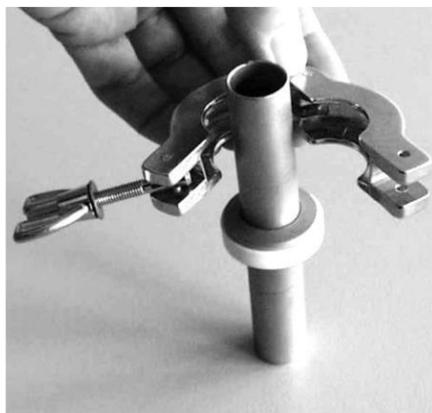
Fig. 44 : Montage du collier de serrage
