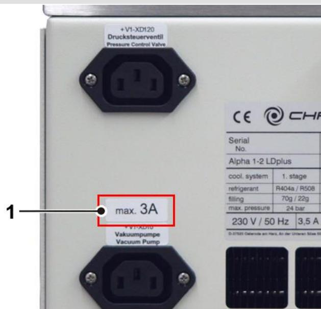
Fig. 13 : Indication de la puissance électrique maximale délivrée à la pompe à vide (exemple)
