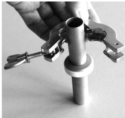
Abb. 58: Ansetzen des Spannrings
