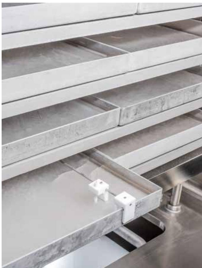
Stellflächen für Bulk-Trocknung mit Halterung für die drahtlose Produkttemperaturmessung WTMplus
