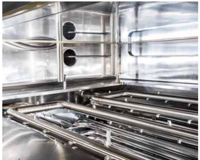
Automatische Reinigung mit CIP-Verfahren
