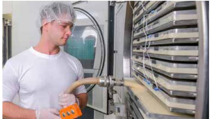
Volumengenaue Befüllung von Gefriertrocknern für die verschiedensten Anwendungen
